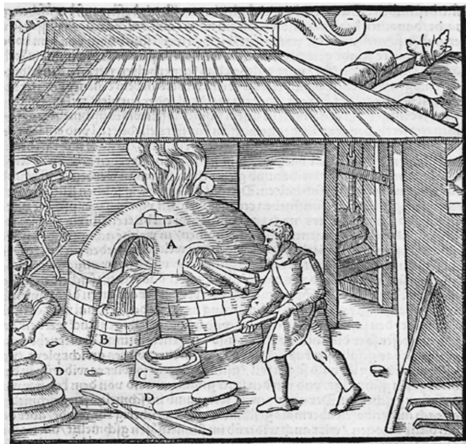
Abb. 12 Schmelzofen zur Silberscheidung, Holzschnitt auf Papier (Georg Agricola)
